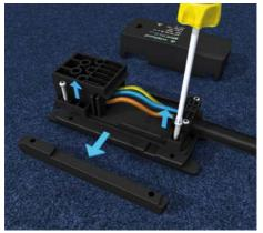
3 | Gehäuse abziehen Zum Einlegen der Flachleitung muss die Verschlussleiste vom Anschlussmodul entfernt werden. Die Verlegerichtung ist zu beachten.
