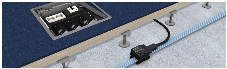
Vorkonfektionierte Gerätebecher komplett mit Snap-In-Gerätebuchse unter dem Gerätebecher, vorverdrahteten 2-fachSchutzkontaktsteckdose, mit 3-poligem Stecker an einer 2m/3m-Anschlussleitung (3 x 2,5 mm²) und Fl/LS-Schalter 6 A, inklusive aller Abdeckungen und Montagematerialien. Zum Einrasten in eine runde oder eckige Einbaueinheit. Zum direkten Anschluss an 5 G 2,5 mm² Flachleitungen, Vorsicherung bis 20 A.
