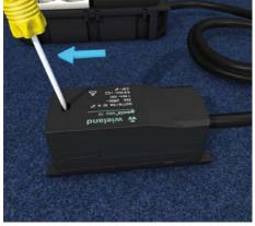
2 | Phase wählen Gehäuse vom Deckel entfernen und Phase wählen. Phase gemäß Lieferzustand auf L1 voreingestellt.
