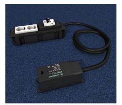
1 | Lieferzustand Der vorkonfektionierte Gerätebecher mit einer 2-fach Schutzkontaktsteckdose wird vollständig vormontiert mit FI/LS-Schalter 16 A, Anschlussleitung, Flachleitungsadapter und Snap-In-Gerätebuchse auf der Unterseite des Gerätebechers geliefert.
