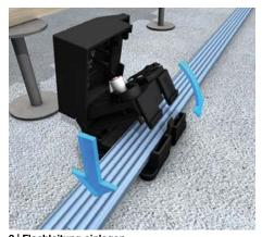
3 | Flachleitung einlegen Flachleitung bündig in die kodierte Bodenplatte einlegen. Verlegrichtung für die Abgangsrichtung der Steckverbinder beachten. Danach das Anschlussmodul schließen.
