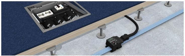
Vorkonfektionierte Gerätebecher komplett mit Snap-In-Gerätebuchse unter dem Gerätebecher, vorverdrahteten 2-fachSchutzkontaktsteckdose, mit 3-poligem Stecker an einer 2m/3m-Anschlussleitung (3 x 4 mm²) und Fl/LS-Schalter 10 A, inklusive aller Abdeckungen und Montagematerialien. Zum Einrasten in eine runde oder eckige Einbaueinheit. Zum direkten Anschluss an 5 G 4 mm² Flachleitungen, Vorsicherung bis 20 A.
