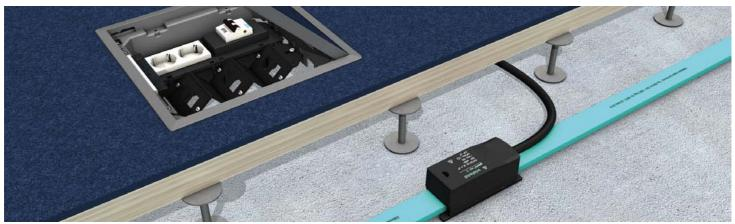
Vorkonfektionierte Gerätebecher komplett mit Snap-In Gerätebuchse unter dem Gerätebecher, vorverdrahteten Steckdosen, Flachleitungsadapter angeschlossen an eine 2 m/3 m Anschlussleitung (3 x 4 mm²) und Fl/LS-Schalter 16 A. Inklusive aller Abdeckungen und Montagematerialien. Zum Einrasten in eine runde oder eckige Einbaueinheit. Zum direkten Anschluss an 5 G 10 mm² Flachleitungen, Vorsicherung bis 50 A.
